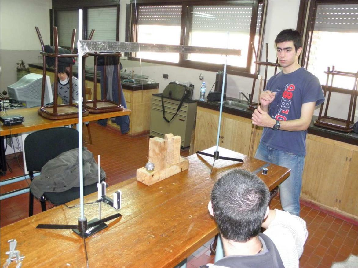
Imagen 1: Regla sostenida por soportes con nueces. El péndulo es sostenido mediante un hilo anudado a otro soporte fijo. El sensor mide los períodos y una placa, conectada a una PC, se encarga de enlistar los datos que son controlados por Agustina.
